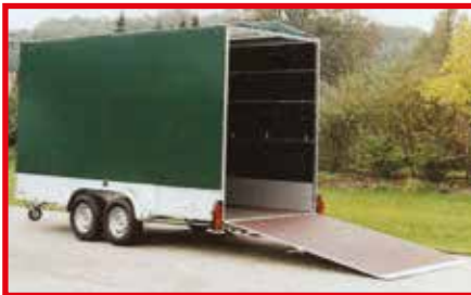
Planenanhänger mit Auffahrrampe und Aero-GFK Vorbau von 4 bis 11 CC-Container
