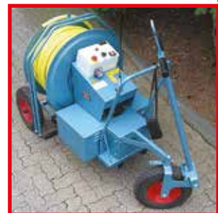
Schlauchwagen mit automatischer Funk- haspel
